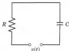
Fig. 147. RC-circuit
