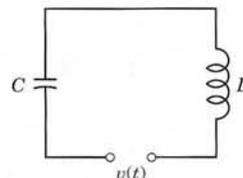
Fig. 148. LC-circuit
