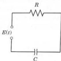
Fig. 66.  $RC$ -circuit
