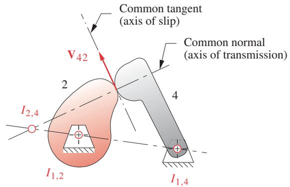
(d) Finding  $I_{2,4}$  without using the effective linkage
